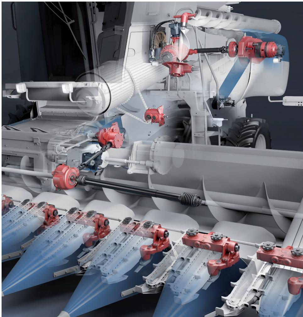
Bondioli & Pavesi ha maturato negli anni un'importante esperienza nello sviluppo di scatole ad ingranaggi e di sistemi integrati per la trasmissione di potenza. Questa capacità progettuale e costruttiva è oggi al servizio dei costruttori di macchine operatrici mobili e industriali per lo studio e la realizzazione di progetti personalizzati.
